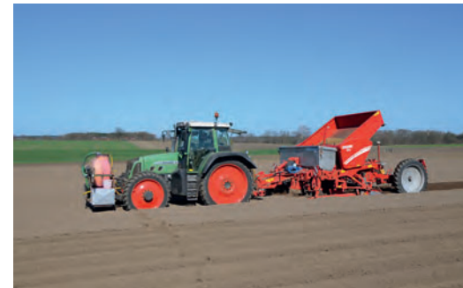
Mit Reihendüngerstreuern können Düngemittel passgenau abgelegt werden.
